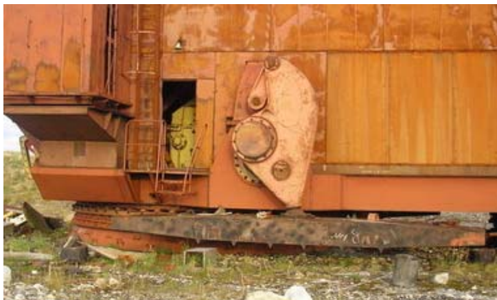
Рис. 1. Кривошипно-рычажная четырехзвенная система механизма шагания драглайна
